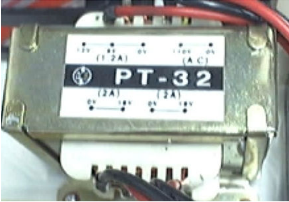
圖 3-55 電源電路所使用之變壓器
